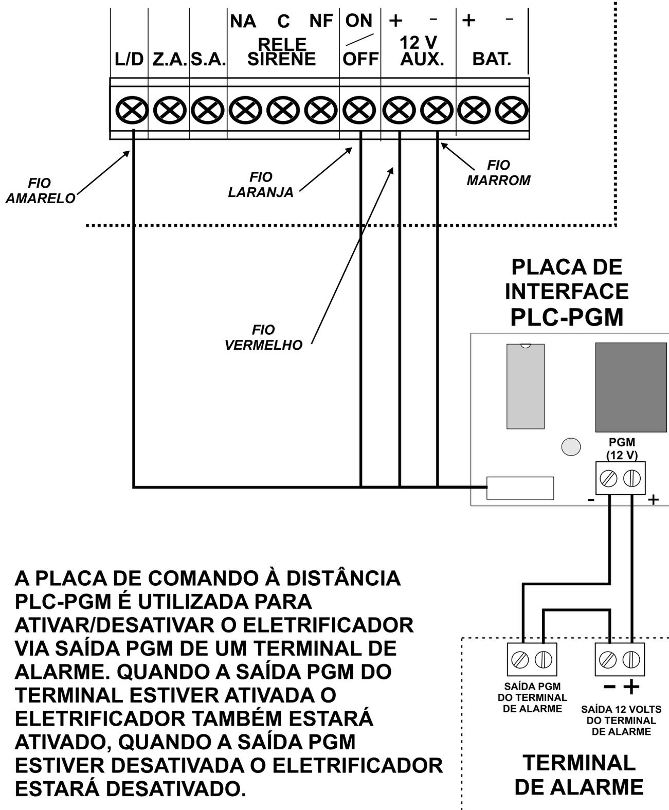
**A PLACA DE COMANDO À DISTÂNCIA PLC-PGM É UTILIZADA PARA ATIVAR/DESATIVAR O ELETRIFICADOR VIA SAÍDA PGM DE UM TERMINAL DE ALARME. QUANDO A SAÍDA PGM DO TERMINAL ESTIVER ATIVADA O ELETRIFICADOR TAMBÉM ESTARÁ ATIVADO, QUANDO A SAÍDA PGM ESTIVER DESATIVADA O ELETRIFICADOR ESTARÁ DESATIVADO.**
